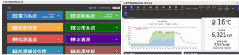
▲ EMS 能源管理及廠區各要單位用電現況顯示面頁
