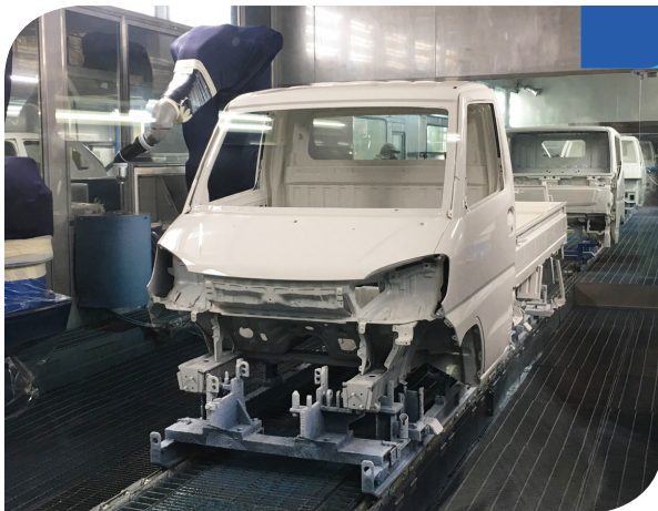
導入塗裝噴塗機械手臂，塗著效率提升至 80% 以上
