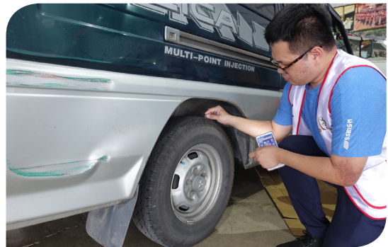
候鳥車輛維修 台灣普利司通技師教導山區車主簡易用銅板檢測胎紋的方法
