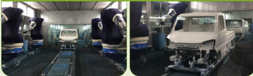
改善後 ( 改採噴塗專用機器人及控制系統 )
