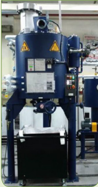
廢溶劑再生回收裝置外觀
